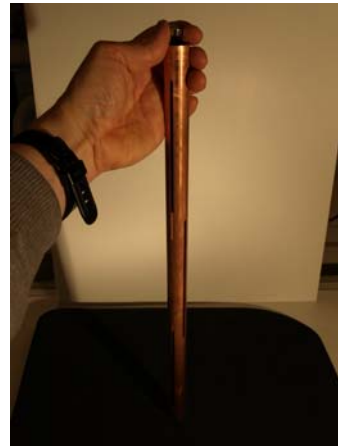
Figur 5.3 Magnet som faller i et kobberør med slisse.
