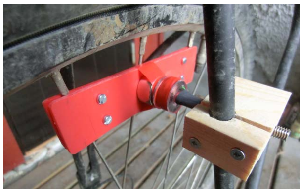
Figur 5.16 Klossen festes til staget som holder bagasjebrettet.
