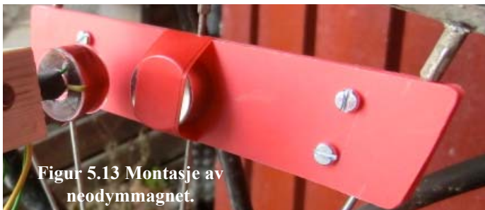
Figur 5.12 En sylindrisk neodymmagnet er festet til to plater av plast som klemmes fast mellom eikene.
