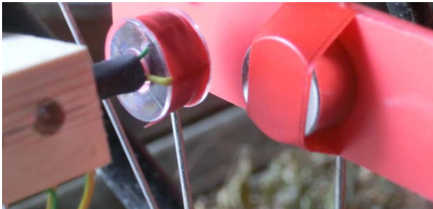
Figur 5.12 En sylindrisk neodymmagnet er festet til to plater av plast som klemmes fast mellom eikene.
