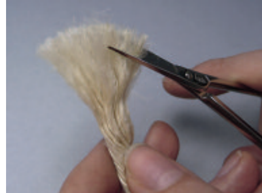
1 | Für die Herstellung einer Kittmasse aus Hanffasern wird eine Hanfkordel aufgefasernd und in ein Millimeter lange Fasern geschnitten.
