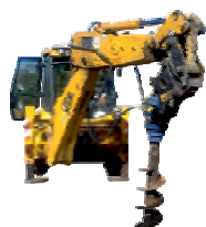
JCB 3CX Super Earth Drill 7000 betonfúró
