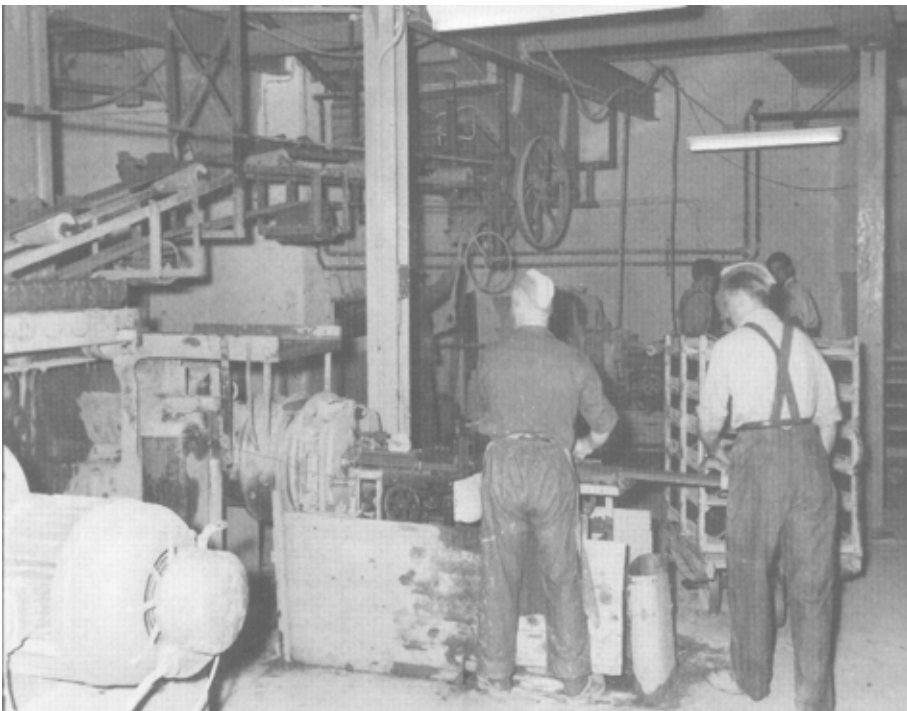
Från Heby Tegelverk ur disponent Sven Sköldbergs fotoalbum . På övre bilden "Ettans tegelpress" i trång och fuktig arbetsmiljö. En naken glödlampa är enda belysning. Undre bilden visar "Tvåans tegelpress" i en något större lokal upplyst med lysrör.
