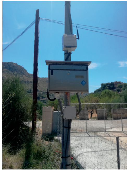
Figura 5. Fotografies del mòdul transmissor instal·lat a l'estació d'Andratx. A l'esquerra un detall de la Lopy amb el convertidor RS232. A l'esquerra el mòdul de comunicació afegit a la part superior de l'estació ja existent.
