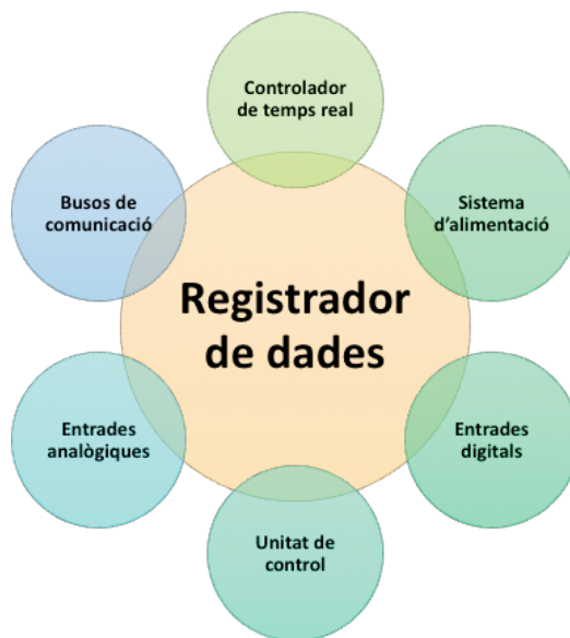
Figura 6. Parts d'una estació de mesura genèrica aïllada
