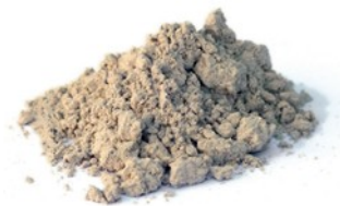
Figura 4. Cal Hidráulica NHL5 empregada para pegar os bloques de Cannabric.
