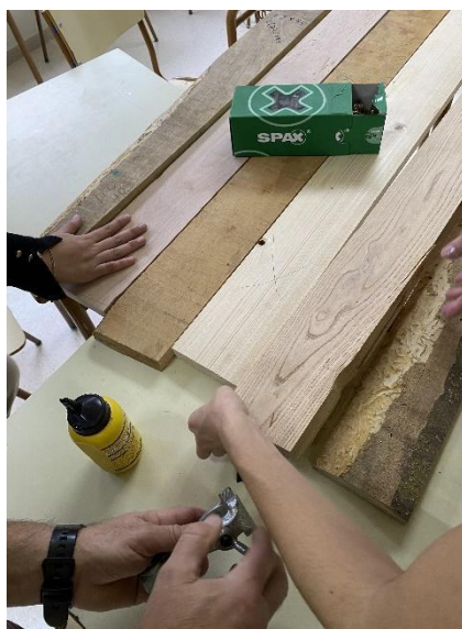
Figura 2. Proceso da unión das táboas.
