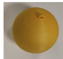
Figura 10. Boya a la que se transmite la energía del tren de olas.
