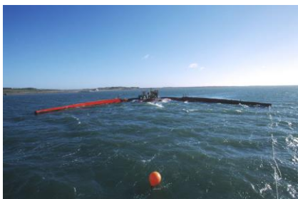
Figura 6. Wave Dragon. Imagen cedida por www.wavedragon.net.
