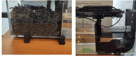
Figura 8. Disipador de olas (izquierda) y pistón para generar el tren de olas (derecha).
