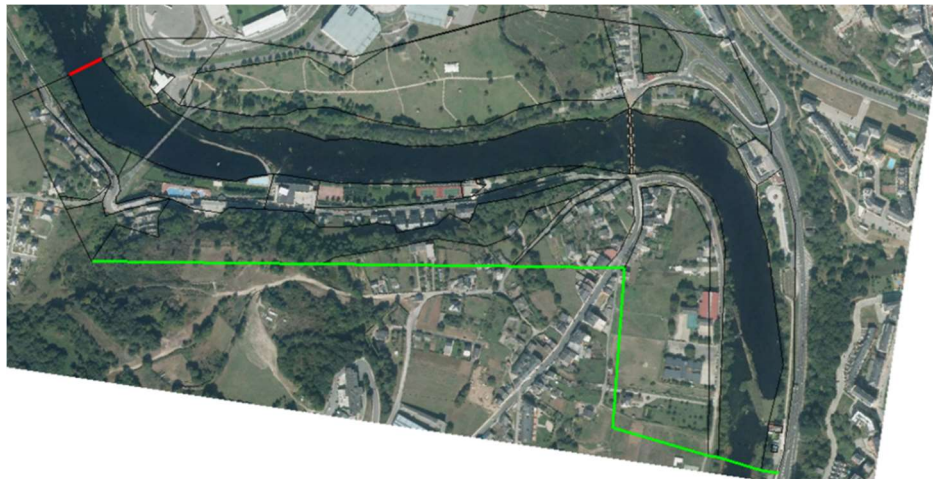
Fig. 6. Situación de la condición de entrada (línea roja) y condición de salida (línea verde) en la zona de estudio.
