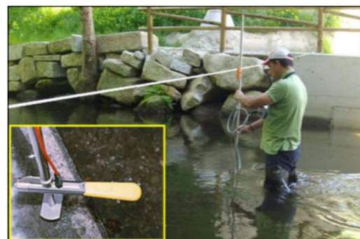
Fig. 3. Medidor electromagnético empleado para la realización de aforos directos. Fuente: CHMS.
