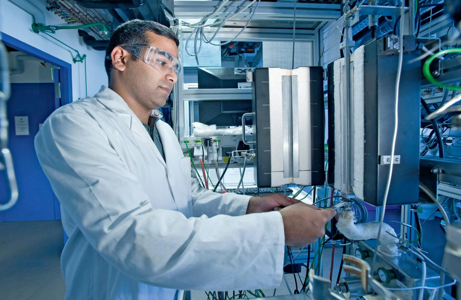
Wie gut arbeitet der Katalysator? Nygil Thomas testet die Aktivität der Reaktionsbeschleuniger, indem er die Ausgangsstoffe unter genau kontrollierten Bedingungen an ihnen zusammenführt und die Produkte analysiert.
