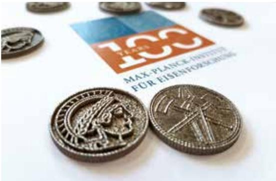
*Ein Beispiel für die Komplexität von Bauteilen, die mit additiver Fertigung hergestellt werden können: Das Logo des Max-Planck-Instituts für Eisenforschung als Relief auf 3D-gedruckten Münzen aus Edelstahl.*
