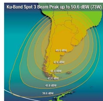
As frequências da banda C encontram-se nos "global", "hemi" e "zone-beams". As frequências da banda Ku encontram-se nos "spot-beams".
