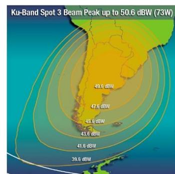
Die Frequenzen des C-Band findet man in den Global-, Hemi- sowie Zone-Beams. In den Spot-Beams befinden sich die Frequenzen des Ku-Bands.
