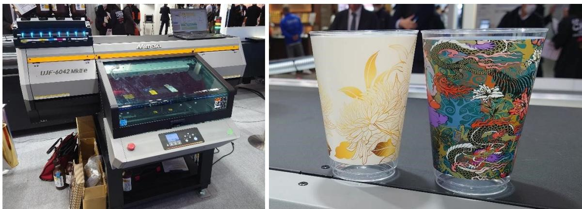
「Kebab HS」を搭載した「UJF-6042 MkIIe」。写真のような角度のついたプラスチックカップに対応し、精緻な模様も複雑な色合いも見事にプリントしてみせる。360度印刷の場合、1時間に6個印刷できる角度は7.5度まで対応
