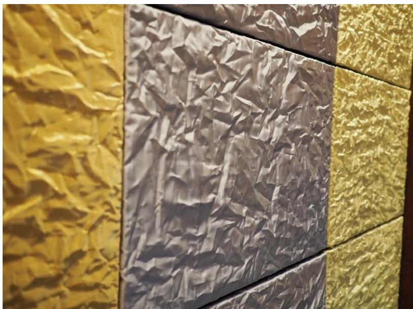
左から直径0.07mm、0.04mm、0.1mmの金属糸で編まれたメッシュ。手作業によりシワ加工を施した。握り方によりシワの細かさや形を調整できる
