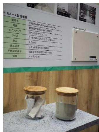
写真上左が「R リース」の端材、右が粉砕された状態で、セメントの原料として活用される
