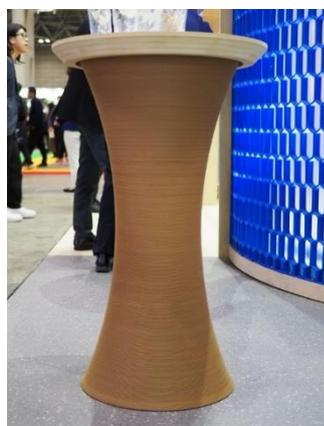
廃材と透明の樹脂を原料としたテーブルの台（天板はFRP）。成形は3Dプリンターによるもの。パーツごとに組み上げられた青色の部材は3Dプリンターで成形している
