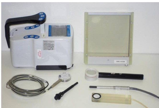
Figur 4 Typiske ionisasjonskamre til å måle kerma og absorbert dose
